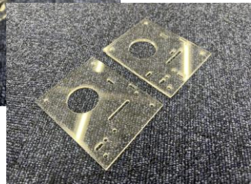
加工機で製作したロボットの機構の一部 (テザー巻取り装置) (つくば工科・ロボット工学科)
